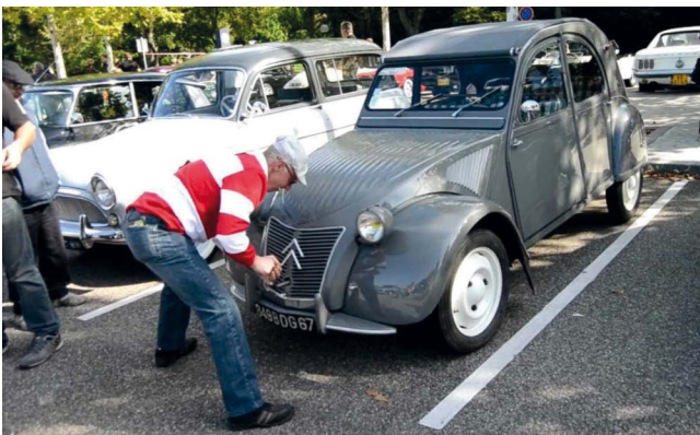
La fonction de la manivelle avant d'être automatisée par le démarreur.
