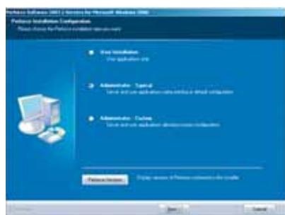
L'installation du serveur Perforce s'effectue par l'exécution du programme d'installation " perforce.exe ". A partir de l'écran des configurations Perforce, choisissez l'option " Perforce Administrator Install (Typical) ",
