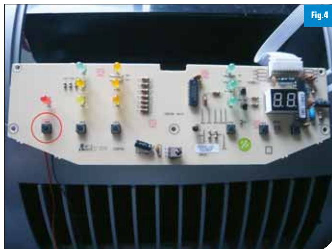
Panneau de contrôle du climatiseur – le bouton de démarrage est celui de gauche
