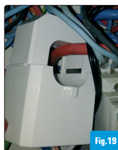
Pince ampère métrique connectée sur la phase
