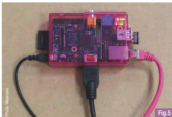
Fig.5 Dissimulé sous la table le Raspberry Pi est maintenu par un adhésif double face
