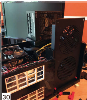
30 La deuxième alimentation est en place. Au premier plan, le double ventilateur est en train d'être sécurisé.
