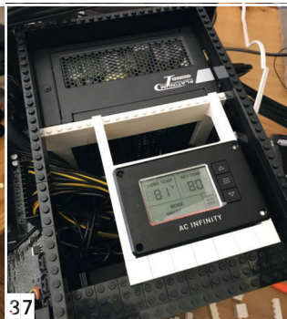
37 Intégration du thermostat, vous pouvez distinguer le câble noir sur la gauche qui emmène la sonde au plus près du processeur.
