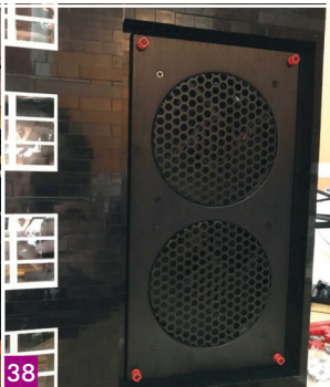
38 Les ventilateurs externes assemblés.
