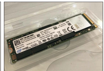
3 Le stockage NVMe ressemble beaucoup aux modules mémoires, à la différence, les connecteurs sont sur le « petit » côté.
