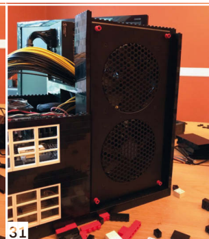
31 Le ventilateur est légèrement encastré pour ne pas avoir de pièces qui dépassent. Sur la gauche, vous pouvez voir l'espace libre pour les nœuds 3 et 4.
