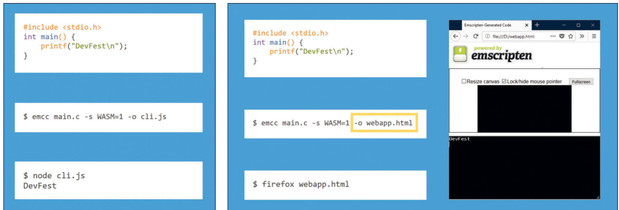
11 Exemple d'utilisation d'emsripten pour compiler du code C pour une utilisation depuis Nodes.js (à gauche) et depuis le navigateur (à droite)
