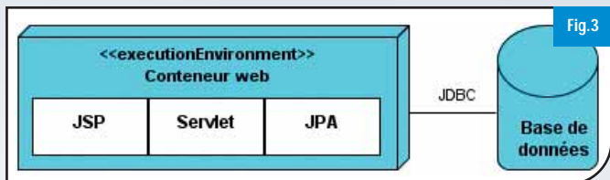
Fig.3 Architecture MVC avec JPA
