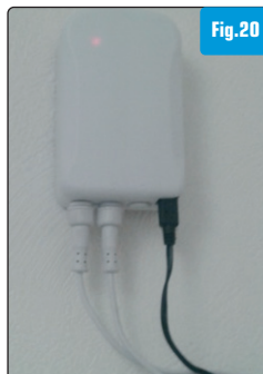
Module HEM en dehors du tableau pour communiquer au contrôleur la consommation électrique des pinces.
