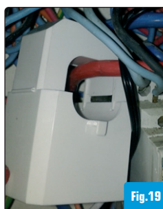
Pince ampère métrique connectée sur la phase
