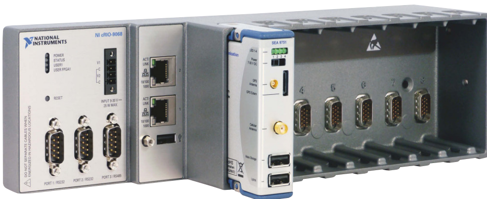
Fig.2 La nouvelle plate-forme de surveillance de l'intégrité des structures de S.E.A. Datentechnik GmbH a pu voir le jour grâce au système d'exploitation temps réel Linux disponible sur le nouveau contrôleur conçu par logiciel cRIO-9068.
