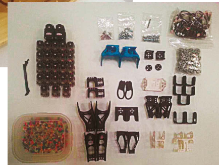
Ensemble des pièces nécessaires pour monter un Poppyrate (hors électronique)
