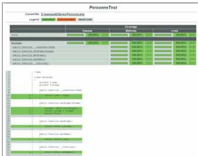
Fig.11 - L'analyse de couverture de code, par fichier, reportée en HTML par PHPUnit.
