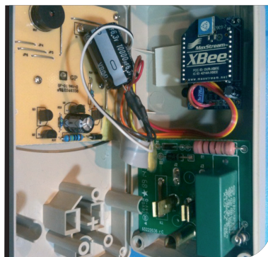
Un analyseur P3 Kill-A-Watt a été modifié pour transmettre les données mesurées par ondes radio à un récepteur connecté à un PC. Un module ESRV ad hoc a été développé. Il est désormais possible d'analyser la consommation énergétique d'un équipement électrique sans fil !
