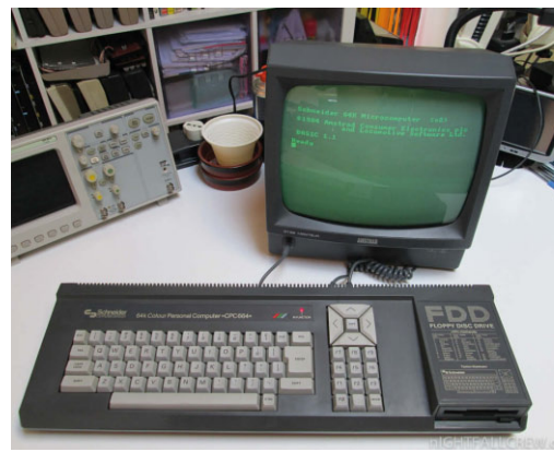
Le CPC 664, distribué en Allemagne sous la marque Schneider, est juste un 464 avec lecteur de disquettes.
